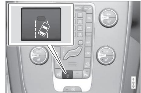
Appuyez sur le bouton de la console centrale pour activer ou désactiver la fonction. Une diode allumée sur le bouton indique lorsque la fonction est activée.
