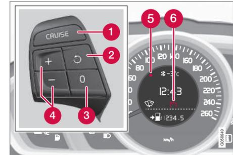
Clavier au volant et écran dans une voiture **sans** limiteur de vitesse<sup>5</sup>.
