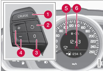
Clavier au volant et écran dans une voiture **sans** limiteur de vitesse<sup>6</sup>.
