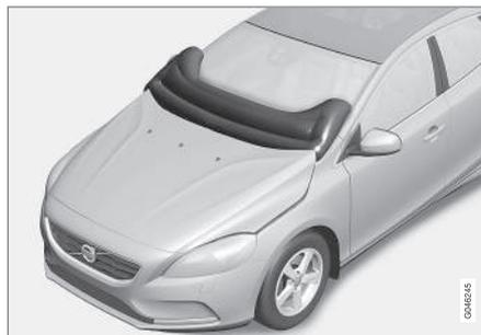
Ce coussin gonflable pour piéton (Pedestrian Airbag) est monté sous le capot moteur, au pied du pare-brise. Dans certaines collisions frontales avec un piéton, les capteurs du pare-chocs avant réagissent et le coussin gonflable est gonflé si la violence de la collision est jugée suffisamment importante. Les capteurs sont actifs à une vitesse d'environ 20 à 50 km/h et à une température ambiante entre -20 et +70 °C.
