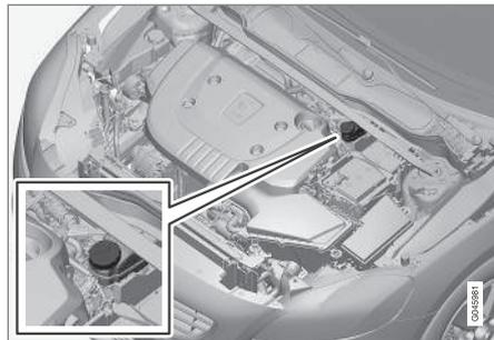
Le réservoir de liquide est placé du côté conducteur.
