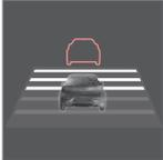
Il est possible de choisir parmi différentes distances temporelles au véhicule qui précède. Elles sont représentées sur le combiné d'instruments par des traits horizontaux (entre 1 et 5) - plus ils sont nombreux, plus la distance temporelle est longue. Un trait correspond à environ 1 seconde jusqu'au véhicule qui précède et 5 traits à environ 3 secondes.
