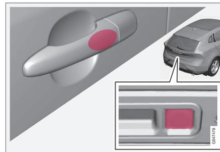
Verrouillez les portes et le hayon simplement en saisissant l'une des poignées de porte ou sur le bouton gainé de caoutchouc le plus petit du hayon. témoin de verrouillage (p. 163) du pare-brise confirme le verrouillage par un clignotement.
