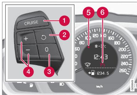
Clavier au volant et écran dans une voiture **sans** limiteur de vitesse<sup>7</sup>.
