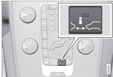
Appuyez sur le bouton de la console centrale pour activer ou désactiver la fonction. Une diode allumée sur le bouton indique que la fonction est activée.
