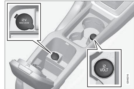
Prise 12 V dans la console du tunnel, sièges avant.
