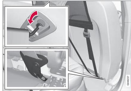
4. Accrochez la sangle du filet dans les œillets arrière des glissières des sièges. Pour faciliter l'opération, mettez les dossiers bien droit et avancez légèrement les sièges.
