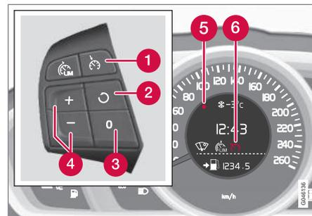
Clavier au volant et écran dans une voiture **avec** limiteur de vitesse<sup>7</sup>.
