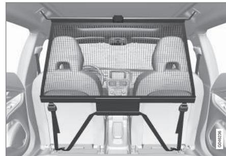
Le filet de chargement se monte sur quatre points de fixation.
