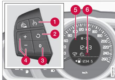
Clavier au volant et écran dans une voiture **avec** limiteur de vitesse<sup>8</sup>.
