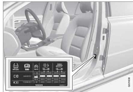
L'autocollant de pressions de pneu sur le montant de porte du côté conducteur (entre la porte avant et la porte arrière) indique quelle pression les pneus doivent avoir à différentes conditions de charge et de vitesse. La pression correcte est aussi indiquée dans le tableau de pressions de pneu.
