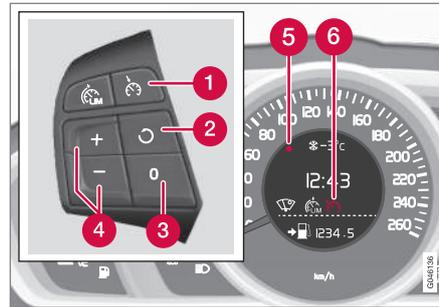
Clavier au volant et écran dans une voiture **avec** limiteur de vitesse<sup>6</sup>.
