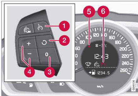
Clavier au volant et combiné d'instruments dans une voiture **avec** limiteur de vitesse<sup>4</sup>.
