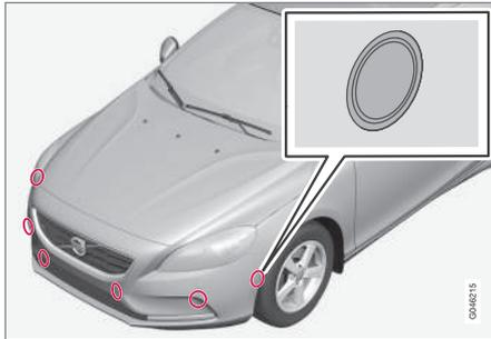
Les capteurs PAP se trouvent dans les pare-chocs<sup>35</sup> : 6 à l'avant et 4 à l'arrière.
