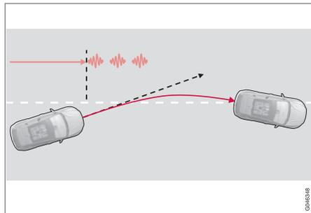
LKA contrôle la direction et donne un avertissement par des vibrations dans le volant<sup>27</sup>.
