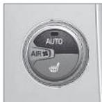
Cette fonction automatique régule automatiquement la température (p. 135), l'air conditionné (p. 136), la vitesse du ventilateur (p. 134), la recirculation (p. 137) et la répartition de
