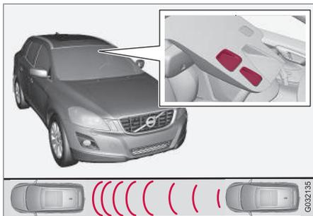
Fenêtre d'émission et de réception du capteur laser<sup>17</sup>.
