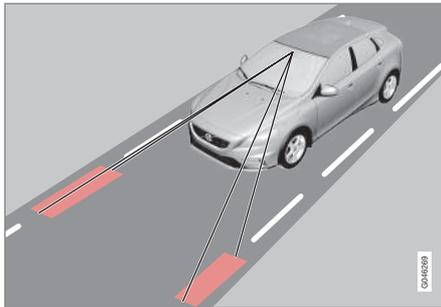
Une caméra lit le marquage au sol indiquant les limites de la chaussée/de la voie de circulation. Si la voiture se met à dévier, l'assistant de sortie de voie remet activement la voiture dans sa voie à l'aide d'un léger couple dans le volant.
