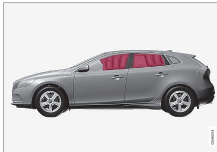
Le rideau gonflable IC (Inflatable Curtain) est un composant Système SIPS (p. 36). Le rideau gonflable est dissimulé dans le ciel de toit des deux côtés de la voiture, il protège les occupants des places extérieures. Lors d'une forte collision, les capteurs réagissent et le rideau gonflable se gonfle.
