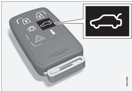
Grâce au bouton de la télécommande (p. 160)
