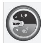
La température peut être réglée séparément du côté conducteur et du côté passager. Appuyez plusieurs fois sur le bouton **L/R** pour sélectionner le côté gauche, le côté droit ou les deux.
