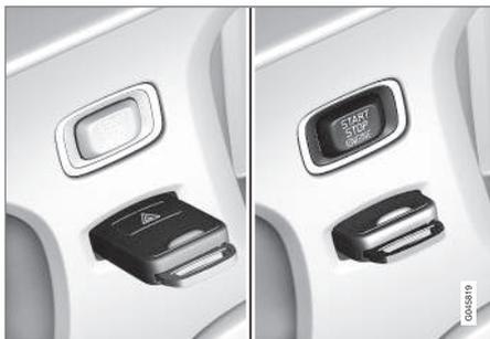
Contacteur d'allumage avec télécommande retirée/insérée.
