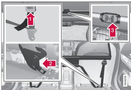
Le filet de chargement peut facilement être déposé et replié.
