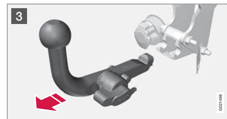
3 บิดปุ่มล็อกลงจนสุดกระทั่งถึงจุดหยุด จับไว้ ณ ตำแหน่งนี้ในขณะที่ดึงตะขอพ่วงออกข้างหลังและดึงขึ้น
