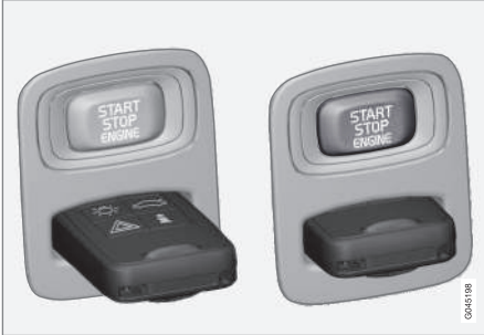
Uzaktan kumanda anahtarlı kontak anahtarı çıkarıldı/takıldı.
