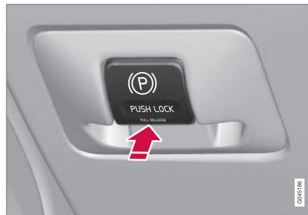
Stāvbremzes vadība - ieslēgšana.
