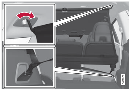
後段安裝位置。
