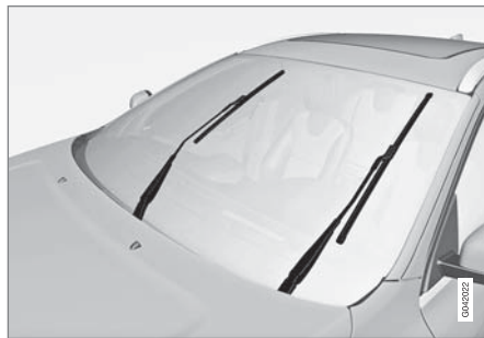
位於維修位置的雨刷片。
