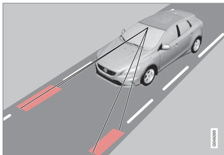
Una telecamera rileva le strisce di delimitazione della strada/corsia di marcia. Quando l'automobile sta per superare una striscia di delimitazione, il mantenimento corsia attivo applica una leggera coppia sterzante sul volante sterzando attivamente l'automobile e facendola rientrare nella corsia di marcia.
