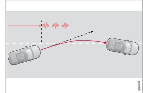
La funzione LKA sterza e avverte il conducente mediante vibrazioni nel volante<sup>31</sup>.
