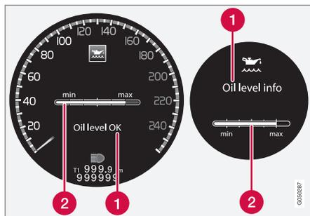
Messaggio e grafico sul display. Il display sinistro è visualizzato nel quadro strumenti digitale e quello destro nel quadro strumenti analogico.
