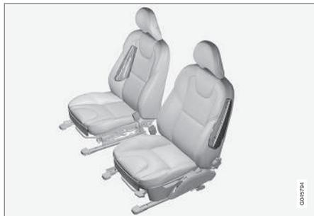
Il sistema airbag SIPS comprende due parti principali: airbag laterali e sensori. L'airbag laterale è posizionato nello schienale anteriore.
