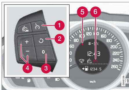
Tastierina al volante e display di un'automobile con limitatore di velocità<sup>3</sup>.
