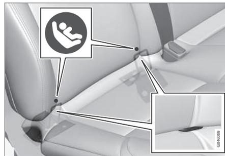
Gli attacchi per il sistema di fissaggio ISOFIX sono nascosti dietro la parte inferiore dello schienale del sedile posteriore, nei posti esterni.
