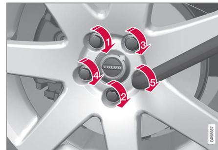
4. Serrare i dadi della ruota in sequenza. È importante serrare i dadi della ruota alla coppia corretta. Controllare la coppia con una chiave torsiometrica.
