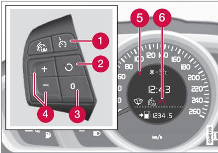
Tastierine al volante e quadro strumenti di un'automobile **con** limitatore di velocità<sup>2</sup>.
