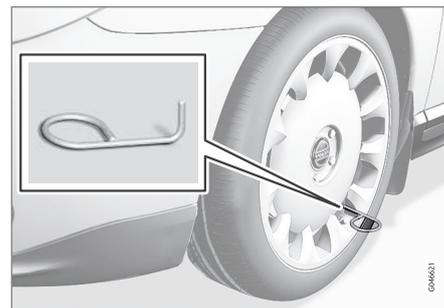
5. Avvitare a fondo l'occhiello di traino con la chiave per i dadi delle ruote\*.
