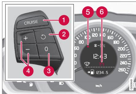
Tastierina al volante e display di un'automobile **senza** limitatore di velocità<sup>6</sup>.
