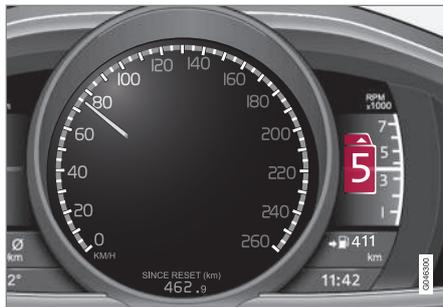
Quadro strumenti "Digital" con indicatore cambio di marcia.
