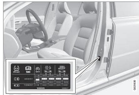
L'etichetta pressione pneumatici sul montante della portiera del conducente (fra portiera anteriore e posteriore) indica le pressioni dei pneumatici richieste in base al carico e alla velocità. Queste sono riportate anche nella tabella delle pressioni pneumatici.
