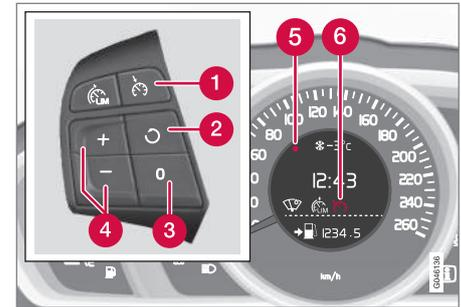
Tastierina al volante e display di un'automobile **con** limitatore di velocità<sup>7</sup>.
