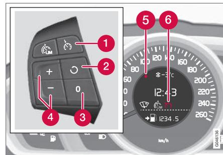
Tastierina al volante e display di un'automobile **con** limitatore di velocità<sup>6</sup>.
