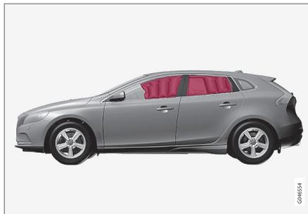
La tendina gonfiabile IC (Inflatable Curtain) fa parte del sistema SIPS (p. 38). È montata nel padiglione su entrambi i lati dell'automobile e protegge il conducente e i passeggeri nei sedili esterni. In caso di collisione sufficientemente forte, i sensori reagiscono gonfiando la tendina gonfiabile.
