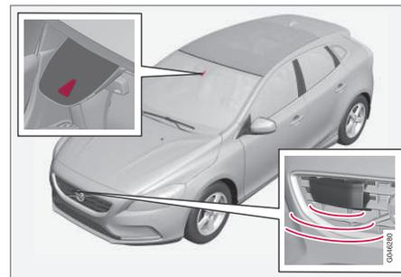
Sensore telecamera e radar<sup>24</sup>.
