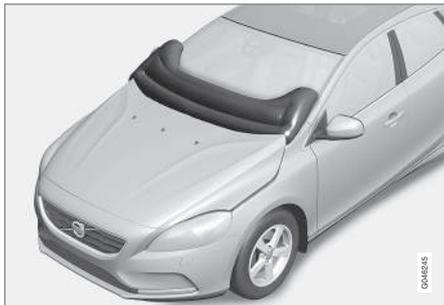
L'airbag per pedone (Pedestrian Airbag) è montato sotto il cofano, accanto al parabrezza. In alcune situazioni di collisione frontale con un pedone, i sensori nel paraurti anteriore rilevano la forza di impatto e l'airbag si gonfia quando essa raggiunge una certa entità. I sensori sono attivi a velocità di circa 20-50 km/h (12-30 mph) e con una temperatura ambiente compresa fra -20 e +70°C.
