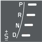
Le posizioni del cambio automatico sono indicate nella parte destra del quadro comandi combinato (è acceso un solo cursore per volta, quello della posizione in cui si trova attualmente la leva seletttrice).
