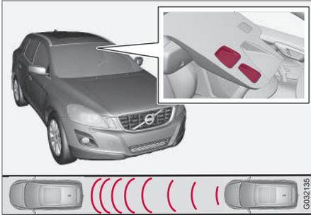
Finestre di trasmissione e ricezione del sensore laser<sup>16</sup>.
