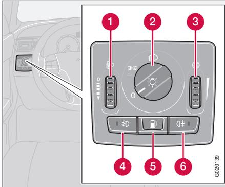
Panneau de commande d'éclairage pour phares halogène.<sup>1</sup>
