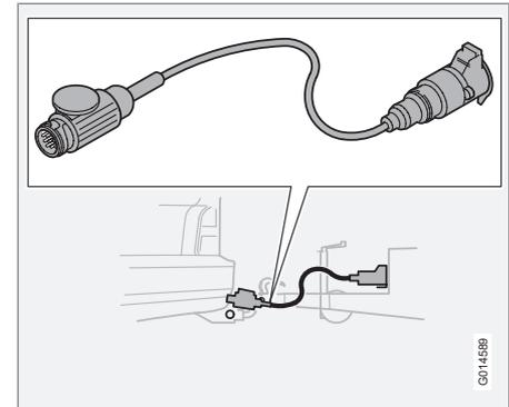
Si le connecteur électrique du crochet d'attelage de la voiture est à 13 broches et celui de la remorque est à 7 broches, un adaptateur sera nécessaire. Utilisez un câble d'adaptateur homologué par Volvo. Assurez-vous que le câble ne traîne pas sur le sol.
