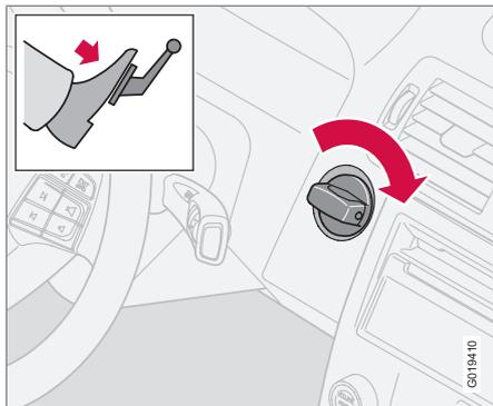
Le système Keyless drive permet de déverrouiller, conduire et verrouiller la voiture sans clé, voir page 138.
