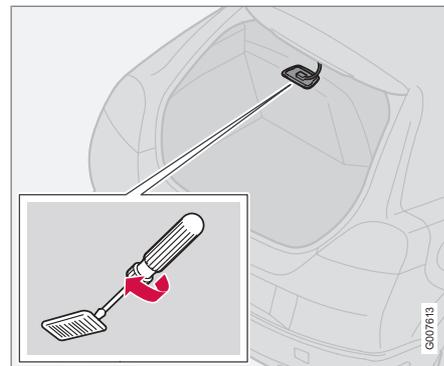
1. Délogez le boîtier d'ampoule en y insérant un tournevis et en faisant légèrement tourner celui-ci.
