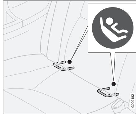
Les points de fixations du système ISOFIX sont dissimulés dans la partie inférieure du dossier de la banquette arrière, aux places extérieures.
