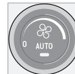
Tournez la molette pour augmenter ou réduire la vitesse du ventilateur. Si **AUTO** est sélectionné, la vitesse du ventilateur est régulée automatiquement. Le précédent réglage de la vitesse de ventilateur est supprimé.
