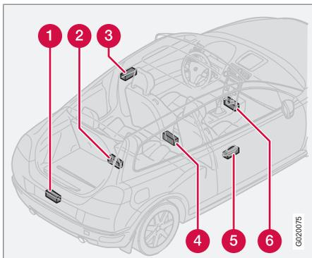
Le système Keyless possède plusieurs antennes intégrées à différents endroits sur la voiture :
