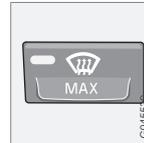
Pour dégivrer et désembuer rapidement le pare-brise avant et les vitres latérales. Le flux d'air est dirigé sur les vitres en utilisant une vitesse de ventilation élevée. La diode du bouton de dégivrage s'allume lorsque la fonction est connectée.
