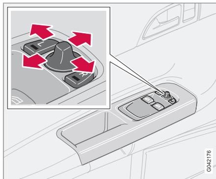
Les commandes pour régler les deux rétroviseurs extérieurs sont placées le plus en avant sur l'accoudoir de la portière du conducteur. Les rétroviseurs peuvent être manœuvrés lorsque le contact est en position **I** ou **II**.
