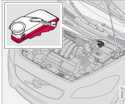
Les liquides de frein et d'embrayage ont le même réservoir<sup>4</sup>. Le niveau doit se trouver entre les repères **MIN** et **MAX** de la jauge. Vérifiez le niveau régulièrement. Remplacez le
