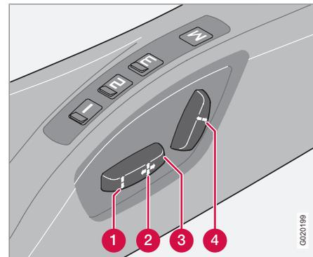
Il est possible de régler le siège un certain temps après avoir déverrouillé la porte avec la télécommande sans insérer la clé dans le contacteur d'allumage. Le siège peut toujours être réglé lorsque le contact est en position I ou II.
