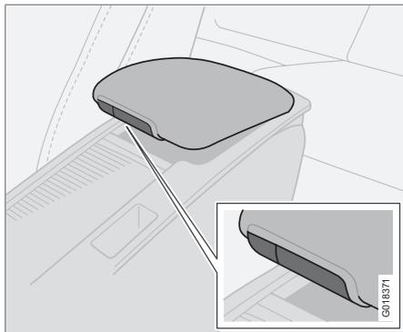
Il y a un compartiment de rangement sous l'accoudoir avant. L'accoudoir divisible comporte également un petit compartiment de rangement. Appuyez sur le petit bouton et levez l'accoudoir pour ouvrir le compartiment. Appuyez sur le gros bouton et levez l'accoudoir pour accéder au compartiment profond.
