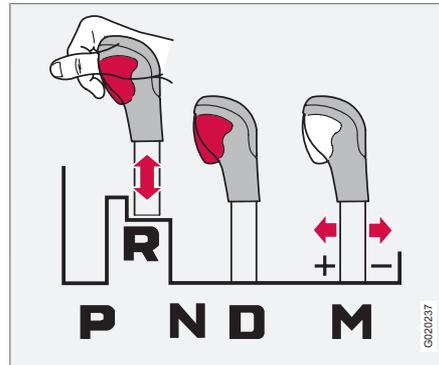
Il est possible de déplacer librement le levier de vitesses d'avant en arrière entre **N** et **D**. Les autres positions sont bloquées par un loquet
