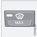
Pour dégivrer et débuer rapidement le pare-brise avant et les vitres latérales. Le flux d'air est dirigé sur les vitres en utilisant une vitesse de ventilation élevée. La diode du bouton de dégivrage s'allume lorsque la fonction est connectée.
