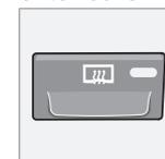
Ce bouton est utilisé pour dégivrer et désembuer rapidement la lunette arrière et les rétroviseurs extérieurs. Une pression sur le bouton active le chauffage simultané de la lunette arrière et des rétroviseurs. Une diode allumée sur le bouton indique que la fonction est activée.
