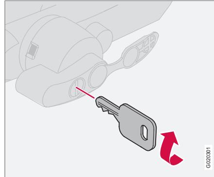
2. Vérifiez que le mécanisme est en position déverrouillée en tournant la clé dans le sens horaire.
