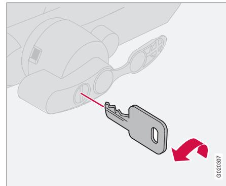
6. Tournez la clé dans le sens antihoraire jusqu'en position de verrouillage. Retirez la clé de la serrure.
