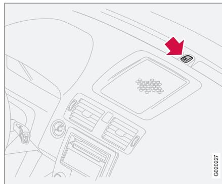
Une diode rouge sur la partie supérieure du tableau de bord indique l'état du système d'alarme :
