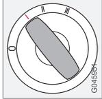
Blocage du volant désactivé. Certaines fonctions sont utilisables. Le système électrique du moteur n'est pas activé.
