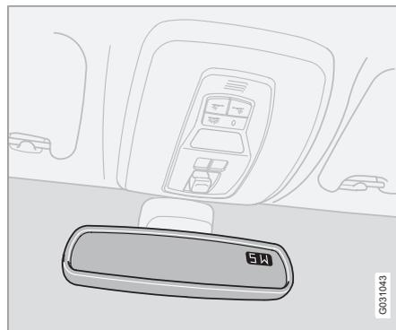
Un écran est intégré dans l'angle supérieur droit du rétroviseur intérieur qui indique la direction de conduite (avant de la voiture). Huit directions différentes sont indiquées avec des abréviations en anglais : **N** (nord), **NE** (nord-
