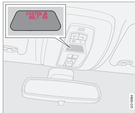
Un rappel lumineux et sonore incite les personnes qui n'ont pas bouclé leur ceinture de sécurité à le faire. Le rappel sonore dépend de la vitesse et parfois du temps. Le rappel lumineux est situé dans la console du plafond et dans le combiné d'instruments.
