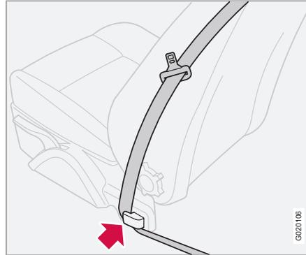
*Le guide de ceinture existe aussi bien sur le siège conducteur que sur le siège passager.*
