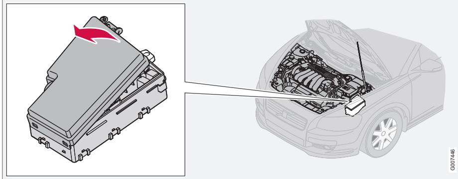
Le boîtier de fusibles contient 36 emplacements de fusible. Assurez-vous de remplacer un fusible grillé par un fusible neuf de même couleur et de même ampérage.
