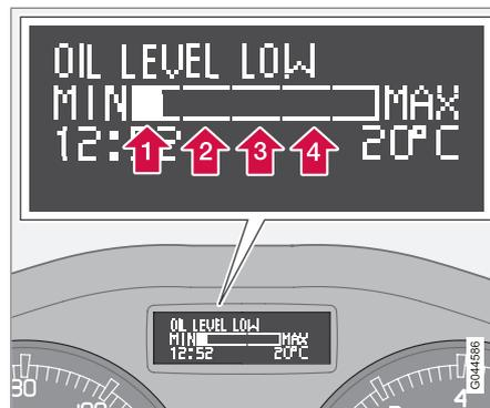
Les chiffres 1 à 4 représentent le niveau de remplissage. Ne rajoutez pas plus d'huile si le niveau de remplissage (3) ou (4) s'affiche. Le niveau de remplissage recommandé est 4.
