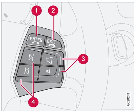
Lorsque le téléphone est activé, les commandes au volant n'agissent que sur les fonctions téléphoniques. Pour pouvoir commander le système audio, le téléphone doit être en mode veille (standby).
