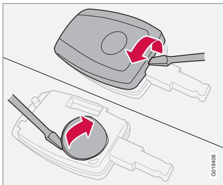
S'il arrive fréquemment que les serrures ne réagissent pas aux signaux de la télécommande à une distance normale, la pile doit être remplacée (type CR 2450, 3 V).
