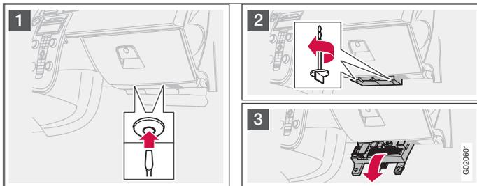
Le boîtier de fusibles contient 50 emplacements de fusible. Les fusibles sont situés sous la boîte à gants. Il existe aussi des emplacements pour les fusibles de rechange. Des outils pour le remplacement des fusibles se trouvent dans le boîtier du compartiment moteur, voir page 261.
