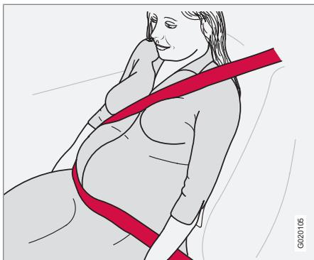
La ceinture de sécurité doit toujours être utilisée pendant la grossesse. Mais il est important de l'utiliser correctement. La ceinture de sécurité doit se coller contre l'épaule et la partie diagonale doit se placer entre les seins et sur le côté du ventre.
