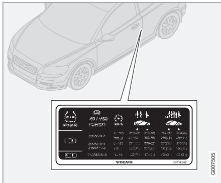
L'autocollant de pressions de pneu sur le montant de porte du côté conducteur indique quelle pression les pneus doivent avoir à différentes conditions de charge et de vitesse.
