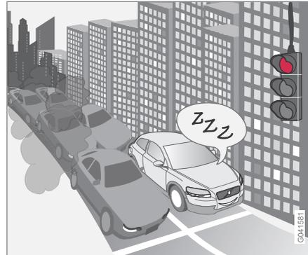
Outre son moteur Diesel au fonctionnement sûr et économique en carburant, cette voiture est aussi munie du système Start/Stop qui est activé lorsque celle-ci est immobilisée dans les embouteillages ou à un feu de circulation. Description détaillée en page suivante.
