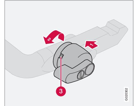
3. Vérifiez que le témoin rouge apparaît dans la lucarne de contrôle (3). Si ce n'est pas le cas, appuyez sur **1** et tournez la poignée en sens inverse des aiguilles d'une montre **2** jusqu'à entendre un déclic.
