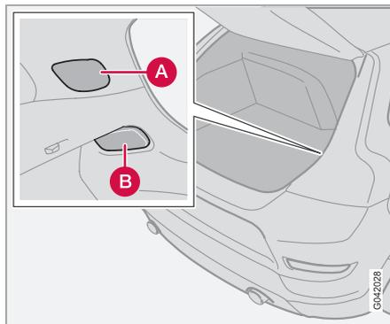
Toutes les ampoules du combiné de lanternes arrière sont remplacées à partir du compartiment à bagages.
