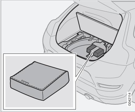
Le kit de réparation provisoire de crevaison permet de réparer une crevaison ou de contrôler et ajuster la pression de pneu. Il se compose d'un compresseur et d'un flacon avec du liquide d'étanchéité. Le kit sert pour une réparation provisoire. Le flacon de liquide d'étanchéité doit être remplacé avant la date de péremption ou après utilisation.
