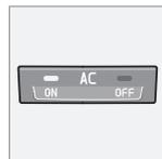
**ON** : La climatisation est activée. La climatisation est contrôlée automatiquement par le système. Dans ce cas, l'air entrant est refroidi et déshumidifié.
