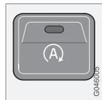
Le message **MOTEUR EN DEM. AUTOMATIQUE** et le témoin vert allumé sur le bouton indique - et rappelle - que le moteur a été automatiquement arrêté.
