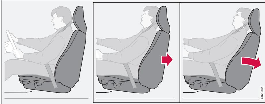
Le système WHIPS (Whiplash Protection System) est constitué de dossiers absorbeurs d'énergie et d'appuie-tête spécifiques intégrés dans les deux sièges avant. Le système est activé en cas de collision par l'arrière en prenant en compte l'angle de la collision, la vitesse et les caractéristiques de l'autre véhicule.
