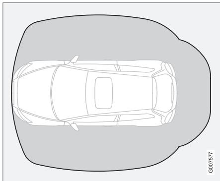
Le système Keyless drive permet de déverrouiller, conduire et verrouiller la voiture sans clé. Il suffit d'avoir la télécommande dans la poche ou dans son sac.
