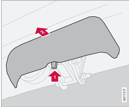
1. Déposez d'abord le cache de protection en appuyant sur le loquet **1** puis en le tirant vers l'arrière **2**.
