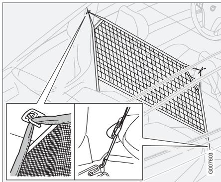
Le filet de protection se place derrière le dossier des sièges avant. L'utilisation du filet de protection n'est prévue que lorsque les dossiers de la banquette arrière sont abaissés. Pour l'arrimage de charge, voir page 203.
