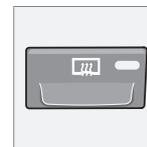
Ce bouton est utilisé pour dégivrer et débuer rapidement la lunette arrière et les rétroviseurs extérieurs. Une pression sur le bouton active le chauffage simultané de la lunette arrière et des rétroviseurs. Une diode allumée sur le bouton indique que la fonction est activée.
