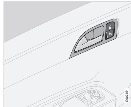
Le bouton du verrouillage centralisé de la porte conducteur permet de verrouiller ou de déverrouiller simultanément les portes et le hayon.
