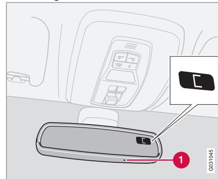
La terre est divisée en 15 zones magnétiques. La boussole est réglée pour la zone géographique dans laquelle la voiture a été livrée. La boussole doit être recalibrée si la voiture change de zone magnétique.
