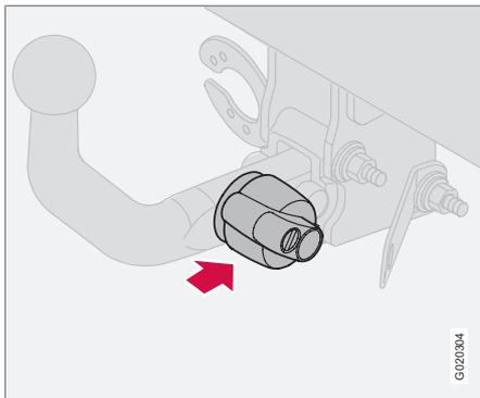
4. Insérez et faites coulisser le crochet d'attelage jusqu'à ce qu'un déclic se fasse entendre.
