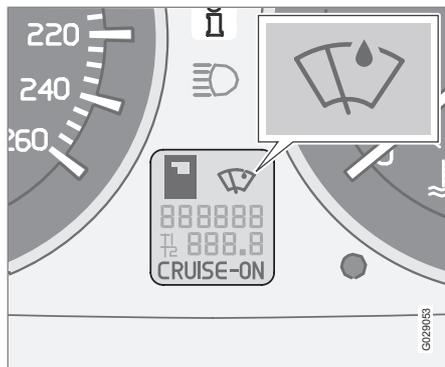
Le capteur de pluie détecte la quantité d'eau sur le pare-brise pour activer automatiquement les essuie-glaces. La sensibilité du capteur de pluie peut être réglée avec la molette (2), voir page 72.
