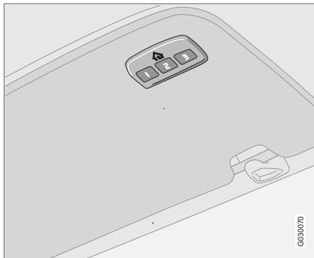
HomeLink®<sup>1</sup> est une télécommande programmable qui permet de commander à distance jusqu'à trois équipements (par exemple un système d'ouverture de porte de garage, un système d'alarme, un éclairage extérieur/intérieur, etc.) et ainsi de remplacer les télécommandes de ceux-ci. Pour plus d'informations sur HomeLink®, visitez : [www.homelink.com](http://www.homelink.com) ou téléphonez au 00 8000 466 354 65 (ou le numéro surtaxé +49 6838 907 277).
