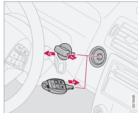
La fonction Keyless drive ne fonctionne pas si la pile de la télécommande est déchargée. Démarrez alors la voiture en utilisant la télécommande comme poignée de démarrage.
