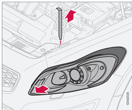
Toutes les ampoules des feux avant (sauf celles des feux antibrouillard) doivent être remplacées en déposant le bloc optique à partir du compartiment moteur.
