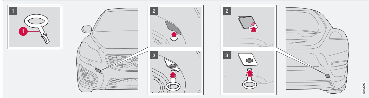
L'œillet de remorquage est fixé dans un orifice fileté situé derrière un cache sur le côté droit du pare-chocs avant ou arrière.
