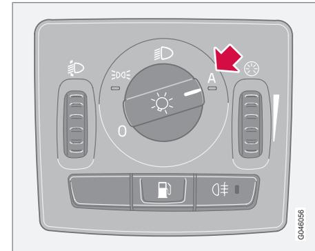
Panneau de commande d'éclairage pour phares halogène avec DRL.
