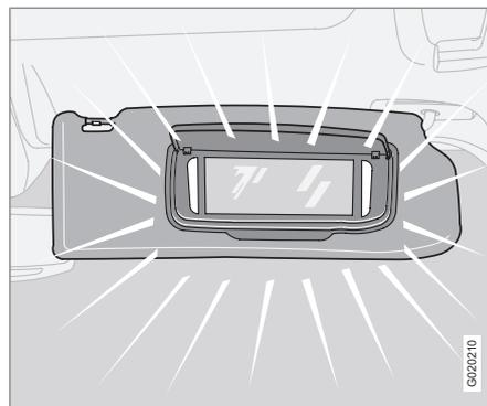
La lampe s'allume et s'éteint automatiquement à l'ouverture et à la fermeture du couvercle.
