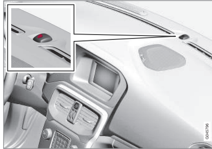
Ta sama dioda LED, co lampka kontrolna alarmu (Str. 190).
