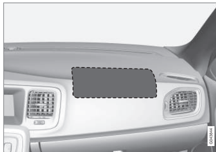
Ubicación del airbag del lado del acompañante en un vehículo con volante a la izquierda.
