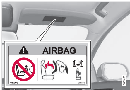
Opción 1: Placa de airbag situada en la visera en el lado del acompañante.
