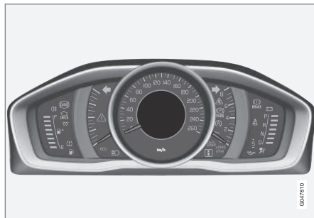
Pantalla de información, cuadro de instrumento analógico.
