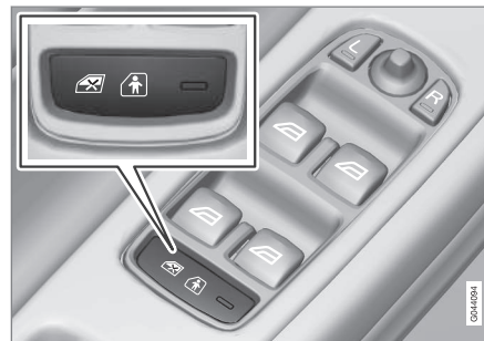
Panel de mandos de la puerta del conductor.
