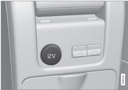
Toma de 12 V en la consola del túnel, asiento trasero.
