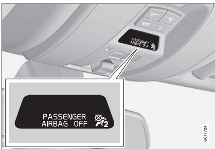
Indicación que muestra que el airbag del acompañante está desconectado.
