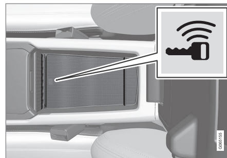
Ubicación del lector de seguridad.
