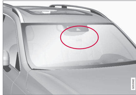
Ubicación de la unidad de radar.
