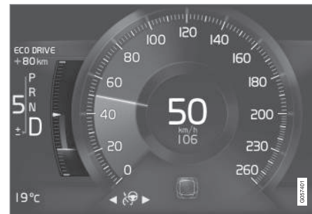
Датчик екологічності на 8-дюймовому дисплеї.
