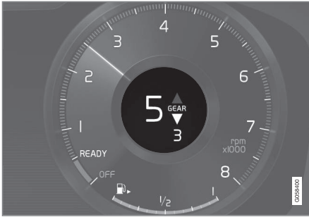
Індикатор зміни передач на 12-дюймовому дисплеї водія.
