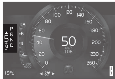
Індикатор зміни передач на 8-дюймовому дисплеї водія.
