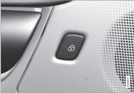
Кнопка замкнення з індикатором на задніх дверцятах.
