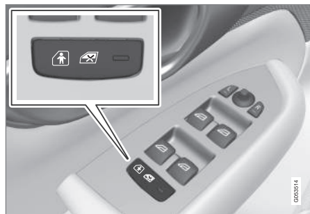
Кнопки увімкнення/вимкнення за допомогою електропривода.
