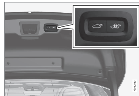
Кнопка зачинення та замикання у нижній частині кришки багажного відділення.
