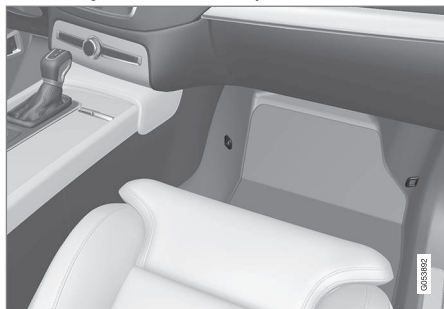
Розташування точок кріплення на передньому сидінні.
