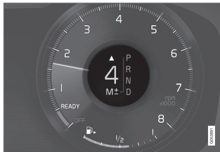
Індикатор зміни передач на 12-дюймовому дисплеї водія.
