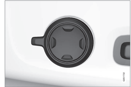
Багатофункціональний регулятор, розташований збоку подушки сидіння.
