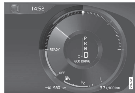
Датчик екологічності на 12-дюймовому дисплеї.
