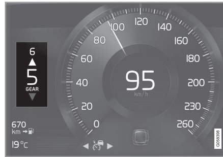
Індикатор зміни передач на 8-дюймовому дисплеї водія.
