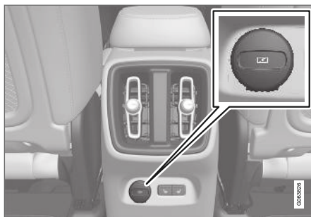
Entrée USB* (type C) à l'arrière de la console centrale pour le chargement des téléphones et tablettes, par exemple 6 .
