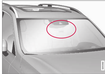
Emplacement du capteur radar.
