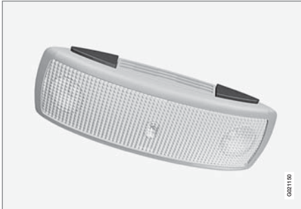
ไฟเพดานด้านหลัง
