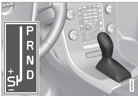
D: ตำแหน่งเกียร์อัตโนมัติ +S-: ตำแหน่งเกียร์ธรรมดา S: โหมดสปอร์ต*
