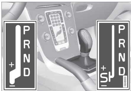
D: Automatiska växellådan. +/-: Manuella växellådan. S: Sportläge*. 6
