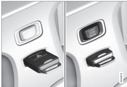
Startlås med fjärrnyckel utdragen/intryckt.
