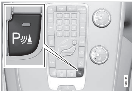
På/Av för sensorerna till Parkeringshjälp och CTA.
