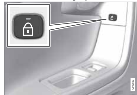
Le témoin du bouton s'allume lorsque la porte est verrouillée.
