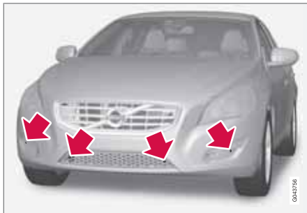
Emplacement des capteurs avant.
