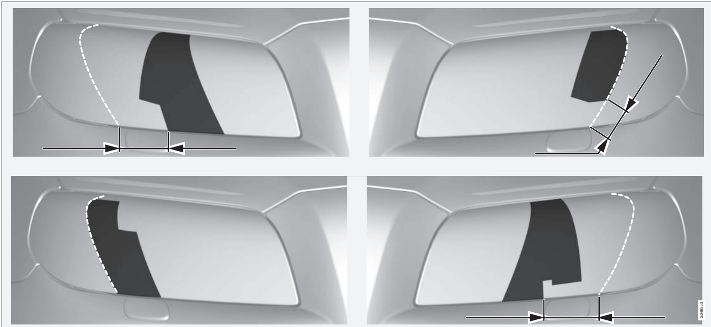
Górny rząd: w samochodzie z kierownicą po lewej stronie, szablony A i B. Dolny rząd: w samochodzie z kierownicą po prawej stronie, szablony C i D.
