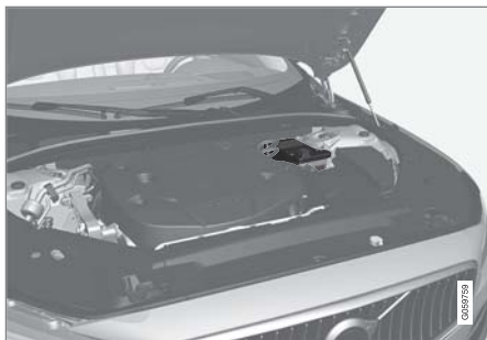
支援電瓶位於支撐桿旁的電瓶箱中。
