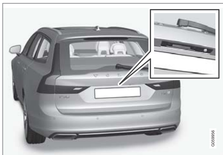
尾門上的橡膠壓板只能用於開鎖。
