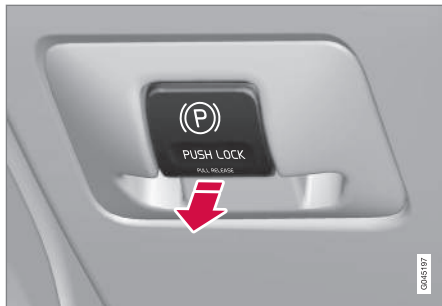
Comando do travão de estacionamento - solto.
