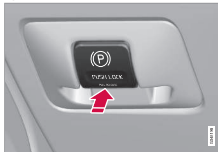
Comando do travão de estacionamento - aplicado.
