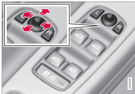
Comando dos retrovisores exteriores.
