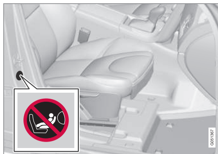
Alternativa 2: Localização do autocolante do airbag no pilar da porta do lado do passageiro. O autocolante fica visível quando se abre a porta do passageiro.
