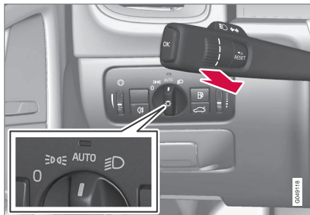
Alavanca do volante e comando das luzes na posição AUTO .
