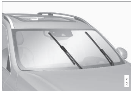
Az ablaktörlő lapátok a szervizállásban.
