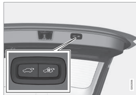
Gomb a záráshoz és nyitáshoz a csomagtérajtó alatt.
