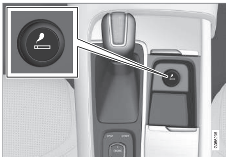
Szivargyújtó az alagútvezetékben, első ülés.
