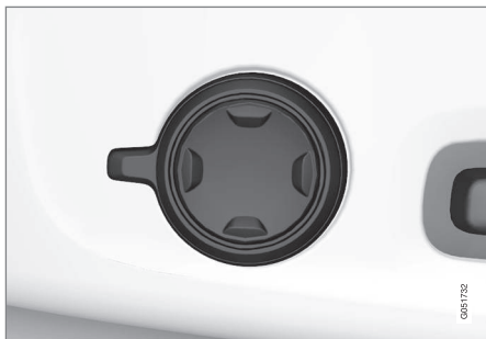
Többfunkciós kezelőszerv, az ülés ülőrészének oldalán.
