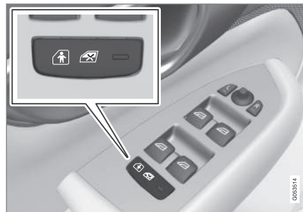
Gomb az elektromos aktiváláshoz/inaktiváláshoz.
