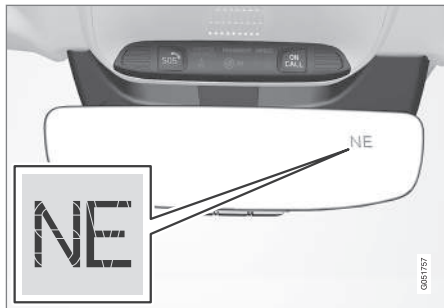
Visszapillantó tükör íránytűvel.
