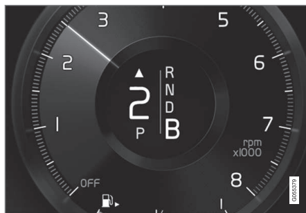
Fokozatváltás-jelző a járművezetői kijelzőn 2
