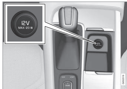
12 voltos elektromos aljzat az alagútkonzolban, első ülés.
