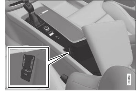
Tünel konsolundaki USB girişleri (tip A). Kapak kapalıyken sıkışmayacağı şekilde kabloyu ileri doğru döşeyin.
