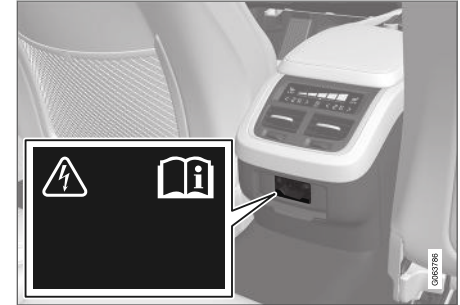
Sähköliitäntä tunnelikonsolissa, takaistuin.
