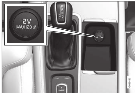
12 V:n sähköliitäntä tunnelikonsolissa, etuistuin.
