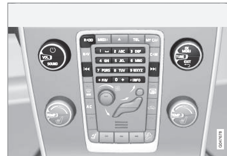
Przyciski podstawowych funkcji radioodbiornika.
