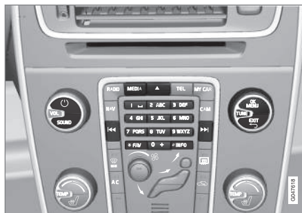
Elementy sterowania odtwarzacza multimedialnego.
