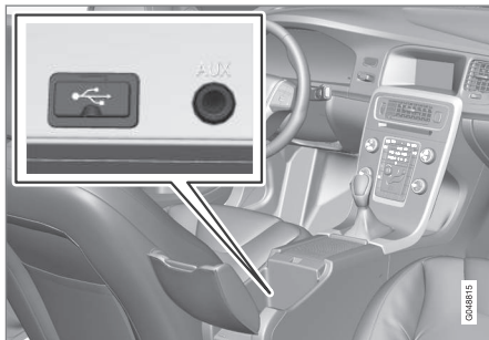
Miejsca podłączania zewnętrznych źródeł dźwięku.
