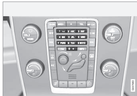
Przyciski pamięci stacji radiowych.
