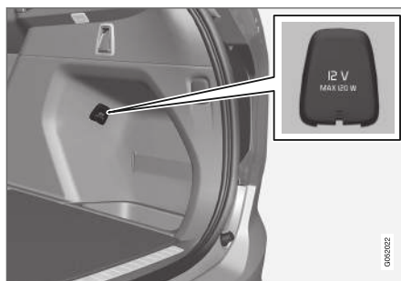
Presa elettrica da 12 V nel bagagliaio*.
