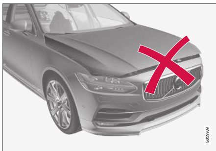
Cofano non completamente chiuso. La figura è schematica - i dettagli possono differire a seconda del modello di automobile.
