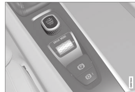
Interruttore di avviamento nel tunnel.
