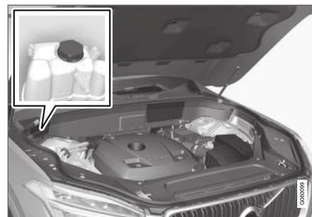
Serbatoio di espansione dell'impianto di raffreddamento.
