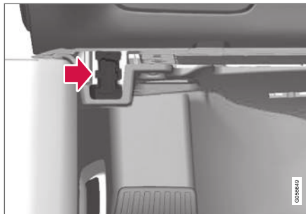
데이터 링크 커넥터(On-board Diagnostic, OBDII)는 운전석 측의 계기 패널 아래에 있습니다.
