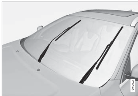
位於維修位置的雨刷片。
