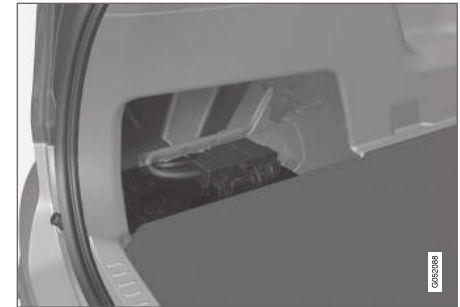
La batería de arranque está situada en el compartimento de carga.
