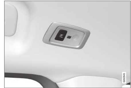
Los vehículos con techo panorámico* tienen dos unidades de luces, una a cada lado del techo. 10
