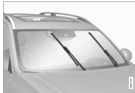
Escobillas de limpiaparabrisas en posición de servicio.
