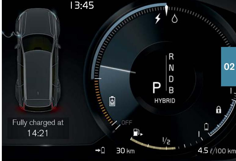
Indique que les fonctions **Chargement** ou **Maintien** sont actives. L'activation se réalise à la vue de fonction de l'affichage central. **Chargement** signifie que la batterie hybride est en cours de chargement si son niveau de charge est bas. **Maintien** signifie que le niveau de la batterie est retenu pour un usage ultérieur.
