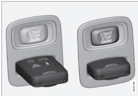
Замок запуска с выдвинутым/вставленным ключом зажигания.
