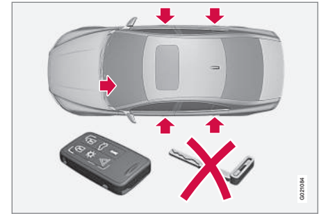
Punti di bloccaggio della chiave del telecomando senza stelo della chiave e con Private locking attivato .
