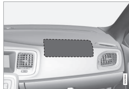
Posizione dell'airbag lato passeggero nelle automobili con guida a sinistra.
