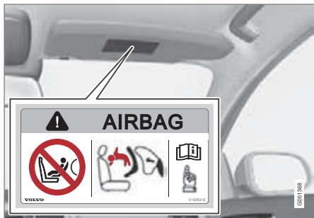
位置 1：助手席側サンバイザーのエアバッグラベルの位置
