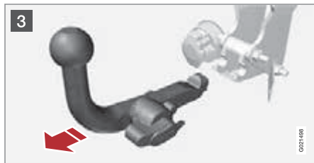
3 ロッキングホイールを下に向けて、止まるまで回します。この位置で保持したまま、トウボールを後方に引き上げます。
