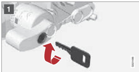
1 キーを差し込んで右に回し、ロックを解除します。
