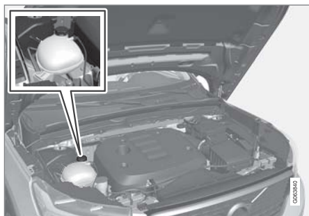
エキスパンションタンク (冷却水)
