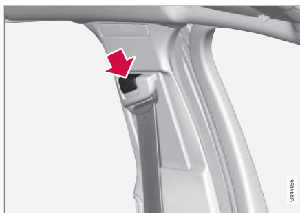
Réglage en hauteur de la ceinture de sécurité. Appuyez sur le bouton et modifiez la hauteur de la ceinture de sécurité. Placez la ceinture de sécurité aussi haut que possible sans qu'elle ne frotte sur la gorge.
