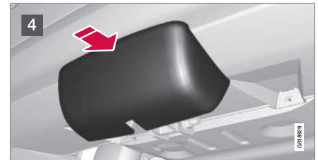
4 Poussez le cache de protection jusqu'à ce qu'il s'enclenche.
