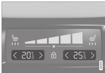
Lämpötilansäädin ilmastointipaneelissa tunnelikonsolin takaosassa.
