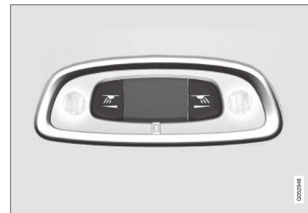
Lukuvalot takaistuimen yläpuolella.
