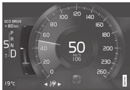
Eco-mittari 8-tuumaisessa kuljettajan näytössä.
