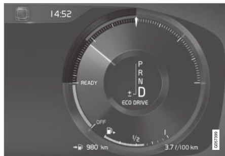
Eco-mittari 12-tuumaisessa kuljettajan näytössä*.
