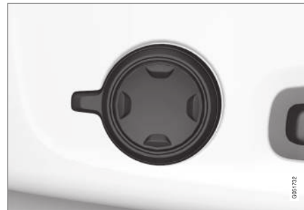
Monitoimisäädin, sijoitettu istuimen istumaosan sivulle.
