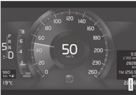
8-tuumainen kuljettajan näyttö.
