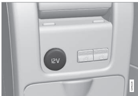
Tomada 12 V na consola de túnel, banco traseiro.
