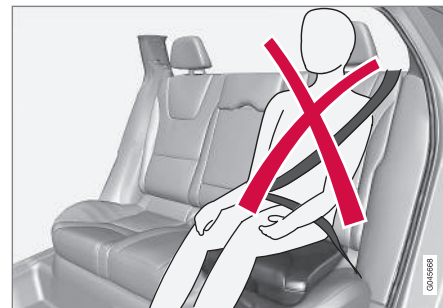
Colocação incorrecta, o encosto da cabeça deve ser ajustado pela altura da cabeça e o cinto não pode ficar abaixo do ombro.
