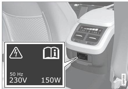
230 V-eluttag i tunnelkonsol, baksäte.
