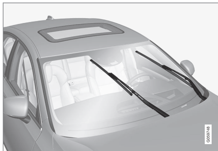
Torkarblad i serviceläge.
