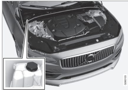
Expansionskärl för kylsystem, vänsterstyrd bil.
