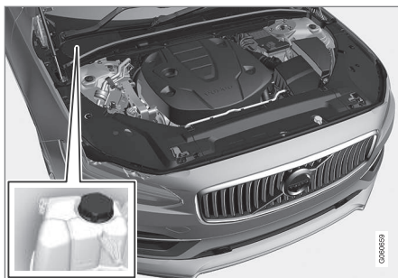
Expansionskärl för kylsystem, högerstyrd bil.
