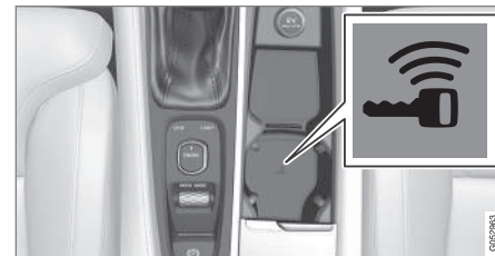
Backup-läsarens placering i tunnelkonsolen.
