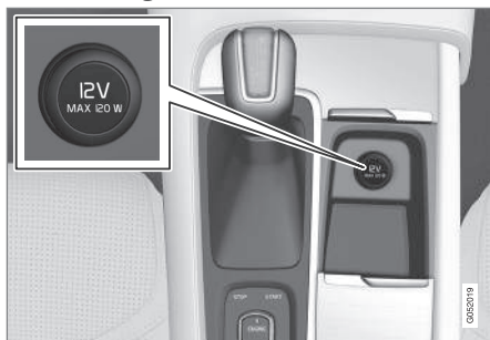
12 V-eluttag i tunnelkonsol, framsäte.
