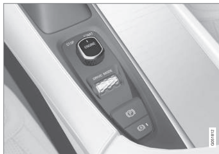
Startvredet i tunnelkonsolen.
