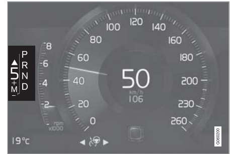
ไฟแสดงการเปลี่ยนเกียร์บนจอแสดงผลสำหรับคนขับขนาด 8 นิ้ว
