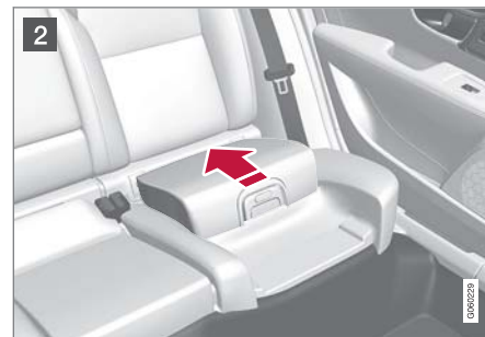
2 ดันเบาะรองนั่งไปทางด้านหลังเพื่อล็อกเข้าตำแหน่ง
