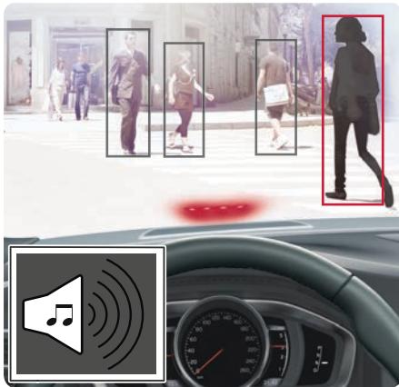
L'automobile è dotata di indicatore di collisione con freno automatico e rilevamento di ciclisti e pedoni, progettato per avvertire il conducente in caso di rischio di collisione con veicoli, ciclisti e pedoni, frenare e/o fermare completamente l'automobile.
