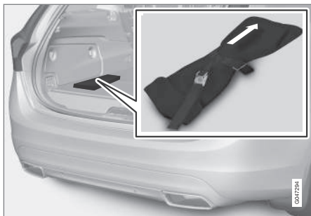
La flecha blanca debe señalar hacia la parte delantera del vehículo.
