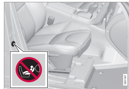
Opción 2: Placa de airbag situada en el montante de la puerta en el lado del acompañante. La placa se ve al abrir la puerta del acompañante.
