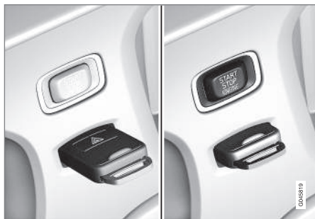
Blocchetto di accensione con chiave telecomando estratta/inserita.
