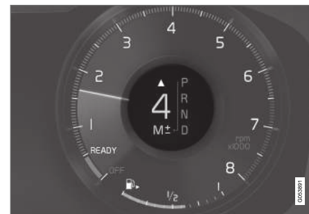
Témoin de rapport de vitesse dans le tableau de bord de 12 po*.
