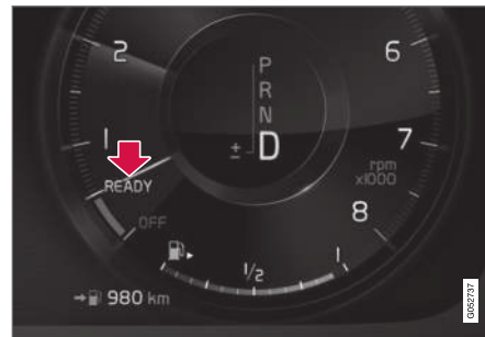
La fonction est active et le moteur du véhicule a été arrêté automatiquement.
