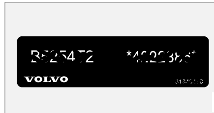
4 Πινάκίδα για τον κωδικό κινητήρα και τον σειριακό αριθμό του κινητήρα.
