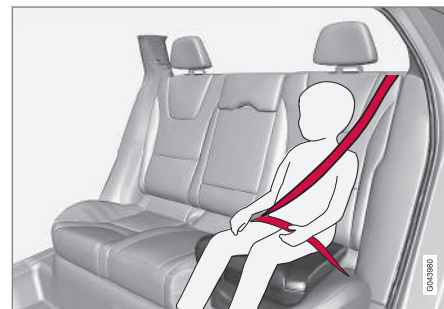
Posición correcta, el cinturón debe colocarse dentro del hombro.
