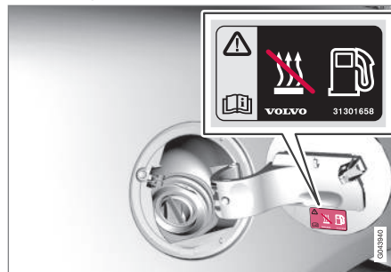
Varselmerke på tankklokke.
