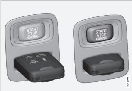
Uzaktan kumanda anahtarlı kontak anahtarı çıkarıldı/takıldı.
