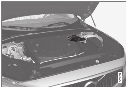
Apuakku sijaitsee laatikossa joustintukitornin vieressä.
