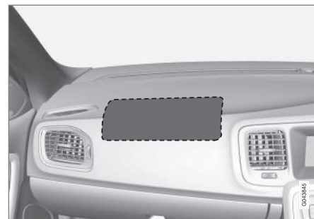
Θέση του αερόσακου συνοδηγού σε δεξιότιμονο αυτοκίνητο.
