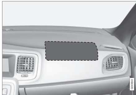
Θέση του αερόσακου συνοδηγού σε αριστεροτίμονο αυτοκίνητο.
