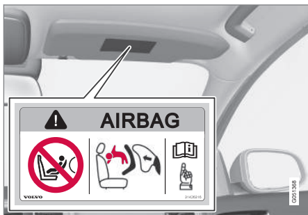
Εναλλακτική 1: θέση της ετικέτας αερόσακου στο σκιάδιο του συνοδηγού.
