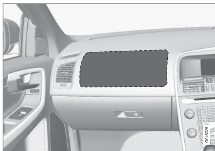
Localização do airbag do lado do passageiro da frente em modelos com volante à direita.
