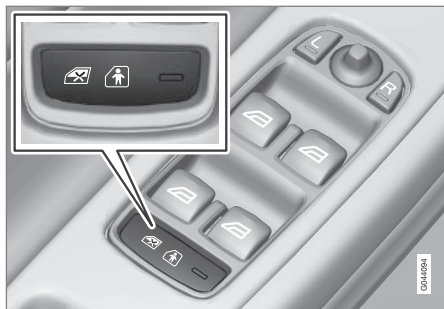
Painel de comando da porta do condutor.
