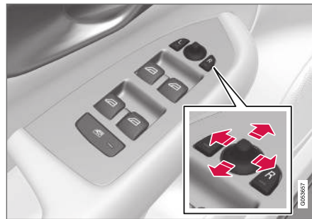
Comando dos retrovisores exteriores.
